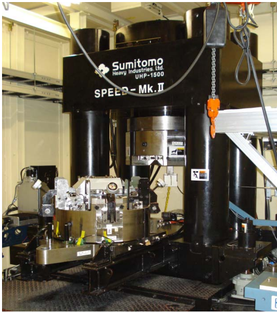
図 1. D-DIA 型変形装置 (左) と高圧力下でのアコースティック・エミッション検出技術の概要 (右)。D-DIA 型変形装置では、超合金製の高圧発生用アンビルを上下左右の 6 方向に配置し、その中心に配置した立方体の高圧力発生容器 (ピンク) 内のプレート岩石試料に高圧力を加える。プレート岩石の破壊及び断層形成の際に発生する特徴的な音波である『アコースティック・エミッション』を高圧発生用アンビルの背面に張り付けた計 6 個のセンサーで検出する。
