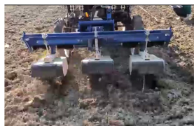
野菜用ロータリカルチでの圃場実験 (中耕作業)
