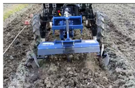
マルチロータリでの圃場実験 (うね形成作業)
