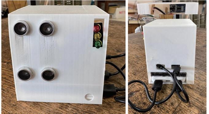
obotや周辺に接続する超音波センサー、LEDライト、モバイルバッテリー、ブザー等が一体的に収納できるようなケースを製作した。
