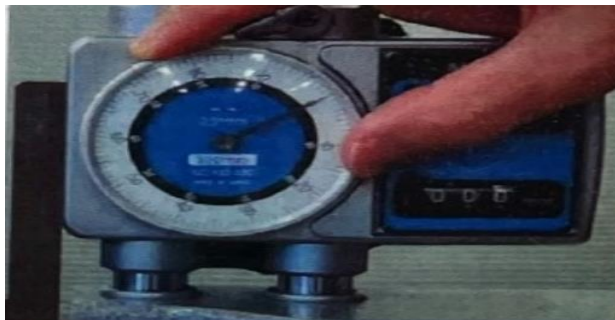
図 17 ハイトゲージの基準の取り方④
