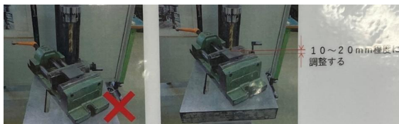
図 42 テーブルの高さ調整 NG (左) 10~20[mm]程度 (右)
