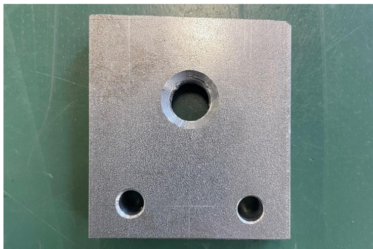
図 116 製作した手動万力回転軸の部品（ボール盤で加工）
