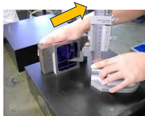
図 18 けがき線の引き方
