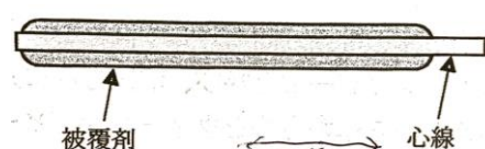
図 94 被覆アーク溶接棒の構造（断面図）
