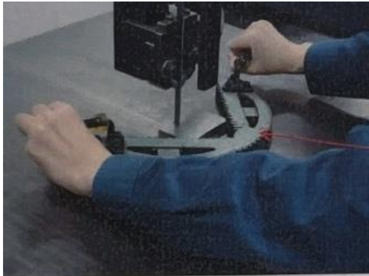
図 113 ハンドホルダーを用いた工作物の押し当ての様子
