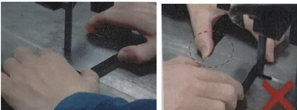
図 112 コンターマシンの工作物の送る様子
