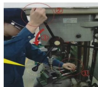
図 45 ボール盤作業様子
