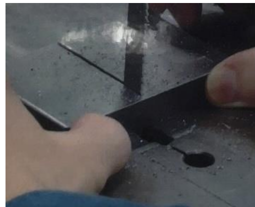
図 115 コンターマシンによる切断終了間
