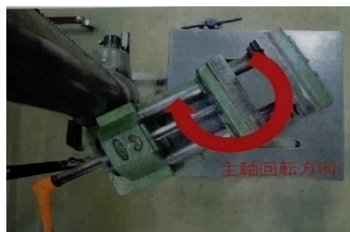
図 40 ボール盤の支柱を使った回り止め
