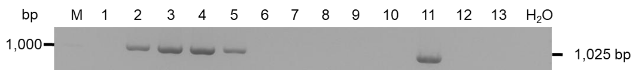
図 7 FLAG-Pinin/pCAGGS で形質転換した大腸菌コロニーの PCR によるスクリーニング
