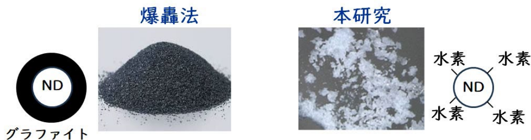
図 5 爆轟法によるナノダイヤモンドと、本研究によるナノダイヤモンド
