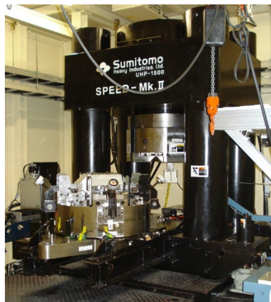
図5：SPring-8に設置のD-DIA型変形装置。
