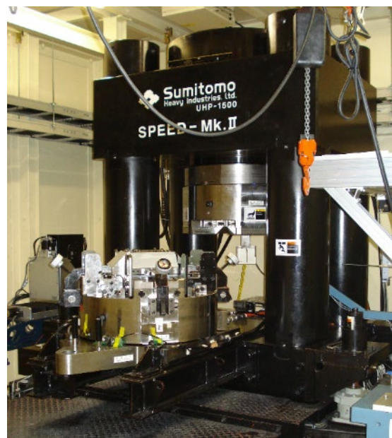
図5：SPring-8に設置のD-DIA型変形装置。
